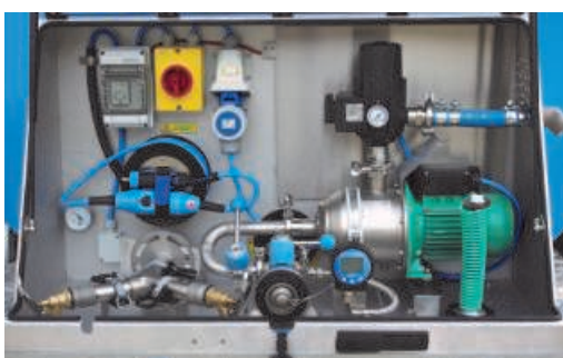
Versorgereinheit mit Pumpe Wilo MHI, Heizung sowie Druck- und Strömungswächter
